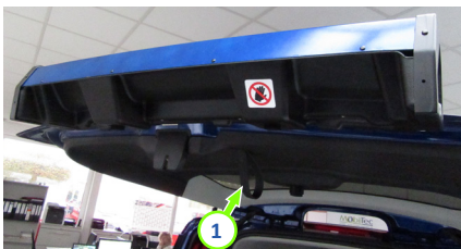
▲ BILD 32 Griff zum schließen der Tür
